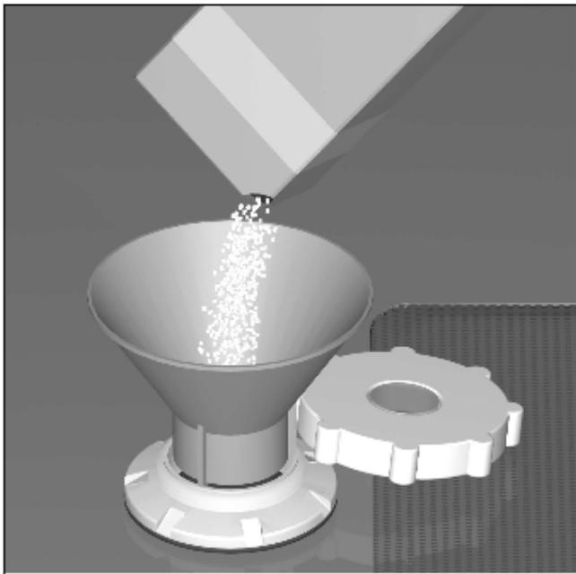
Das Salznachfüllen muss immer unmittelbar vor dem Einschalten des Gerätes erfolgen, um Korrosion zu vermeiden. Dadurch wird die übergelaufene Salzlösung sofort verdünnt und ausgespült.
